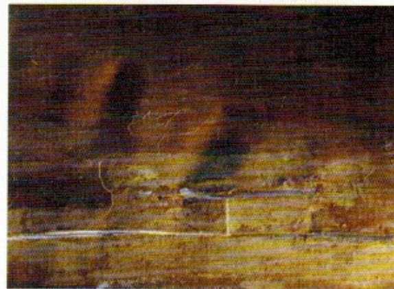
Deformaciones y roturas del tejido (reverso).
